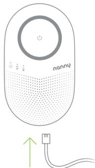
4. Schließen Sie das Verbindungskabel an die Kontrolleinheit über eine der Buchsen an. Der Stecker muss beim Einlegen einrasten und halten.
